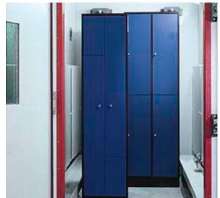
Salzsprühkammer mit zwei Garderobenschränken, die als komplettes Produkt nach DIN 50021 bei C+P geprüft werden.
