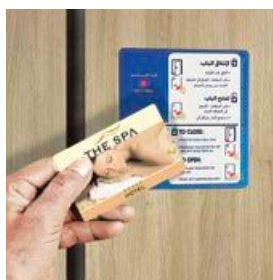
Online-Schließsystem mit zentralem Info-Terminal, mit PIN oder Transponder/Datenträger
