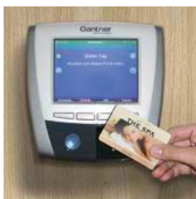
Online-Schließsystem mit zentralem Info-Terminal, mit PIN oder Transponder/Datenträger
